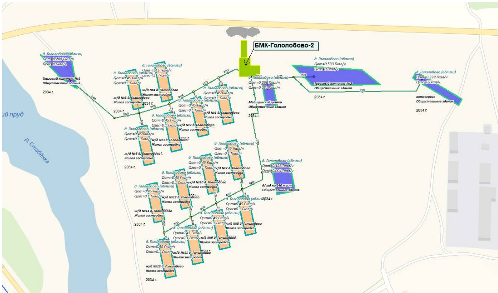
Рисунок 3.34 - Графическое представление планируемых к вводу в эксплуатацию тепловых сетей в ГО Зарайск (рис. 3 из 3)
