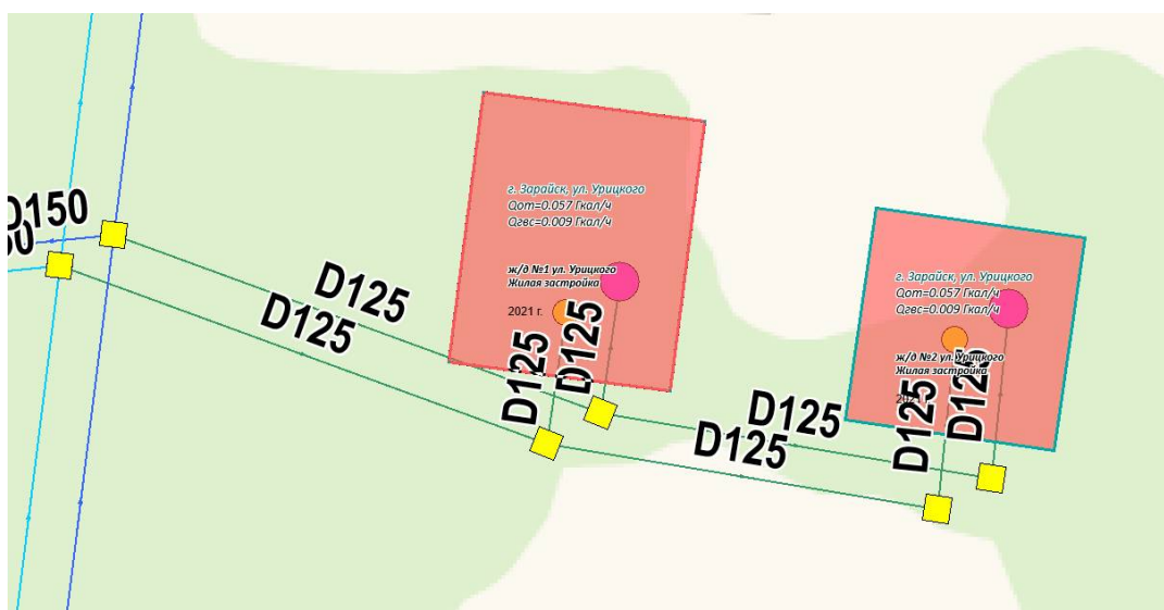
Рисунок 3.32 - Графическое представление планируемых к вводу в эксплуатацию тепловых сетей в ГО Зарайск (рис. 1 из 3)
