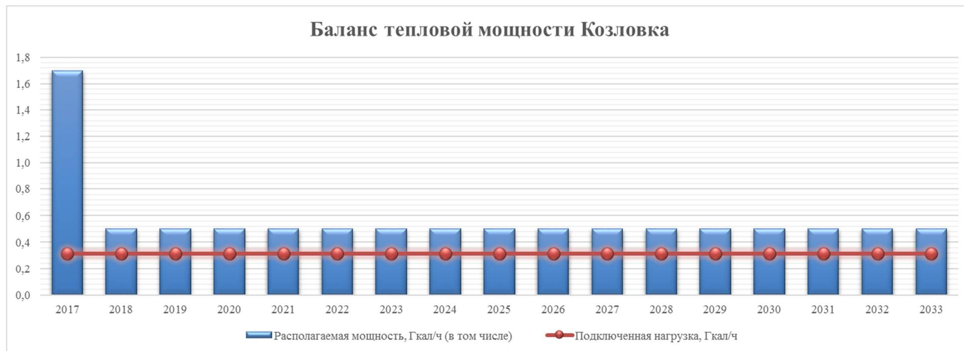
**Рисунок 4.8-25- Перспективный балансы тепловой мощности котельной Козловка**
