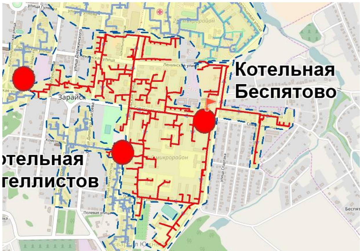
Рисунок 1.1.4-3 - Ситуационная схема зоны действия котельной Беспятово
