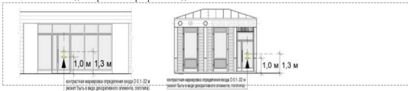
Рис. 37. Внешний вид контрастной маркировки входа.
